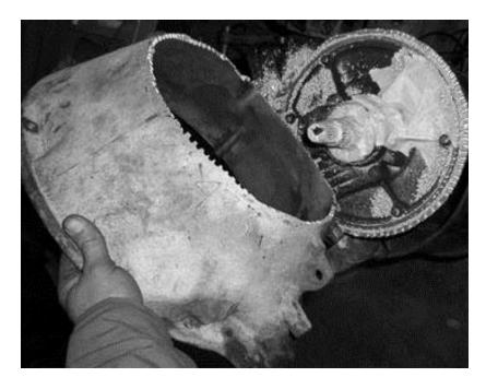
6. ONCE THE BELLHOUSING HAS BEEN REMOVED, CUT AWAY ANY PART OF THE CASE THAT SITS HIGHER THAN THE LIP AROUND THE FRONT PUMP OR HIGHER THAN 3/8" ABOVE THE SURFACE OF THE FRONT PUMP
