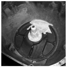
3. LOOKING DOWN THE FRONT OF THE TRANSMISSION, STARTING AT WHAT WOULD BE THE 8 O'CLOCK, USING A 1/4" DRILL BIT, DRILL AROUND THE INSIDE OF THE CASE TO THE 4 O'CLOCK POSITION. PUT THE HOLES AS CLOSE AS POSSIBLE TO EACH OTHER MAKING CERTAIN TO ONLY DRILL THROUGH THE BELLHOUSING PORTION OF THE CASTING. THE DANGER AT THIS POINT IS DRILLING INTO THE INTERIOR OF THE TRANSMISSION CASE. THE FURTHER AWAY FROM THE CASE YOU CUT, THE MORE HAND WORK IS REQUIRED.
